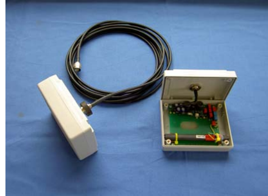
MSF Antenna module
